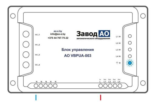
После первого включения Блок управления AO VBPUA-002 перейдёт в режим быстрого сопряжения. Светодиодный индикатор WI-FI начнёт мигать в режиме «два раза коротко, один раз длинно».
